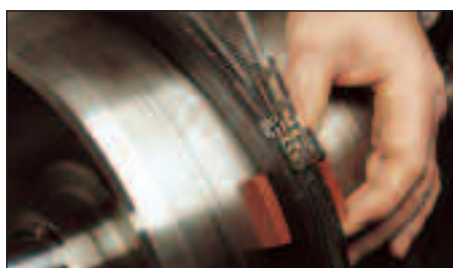
Schritt 3: Stahlband anziehen
